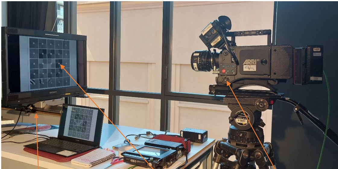
Banc optique (précision 0,01 cm) Mire de Foucault affichée sur écran de retour afin de faire varier le grandissement (plus facile pour certaines focales) Couple caméra/optique à tester
